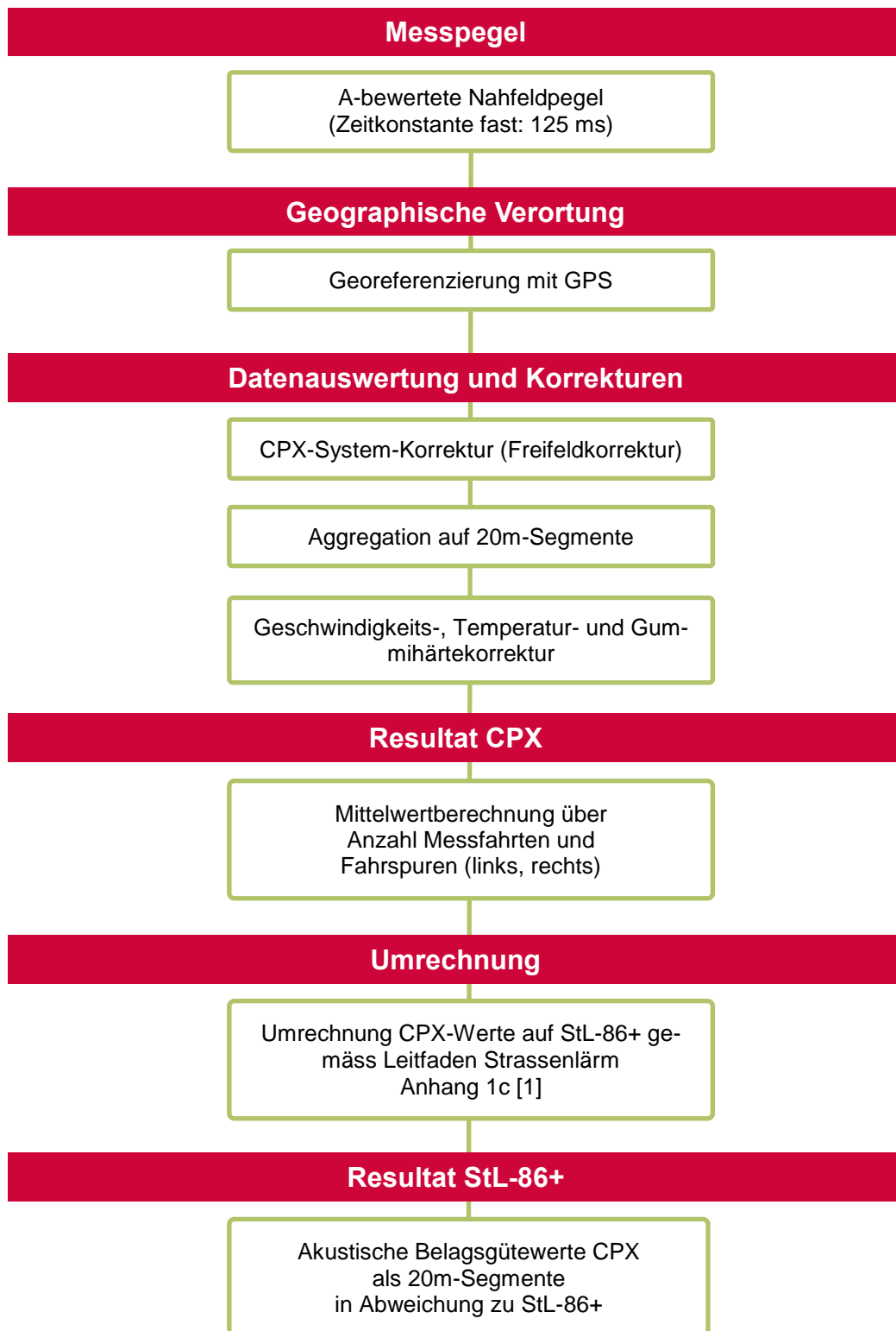
Abb. 5.3 Schema zum Vorgehen bei der Datenauswertung von CPX-Messungen.
