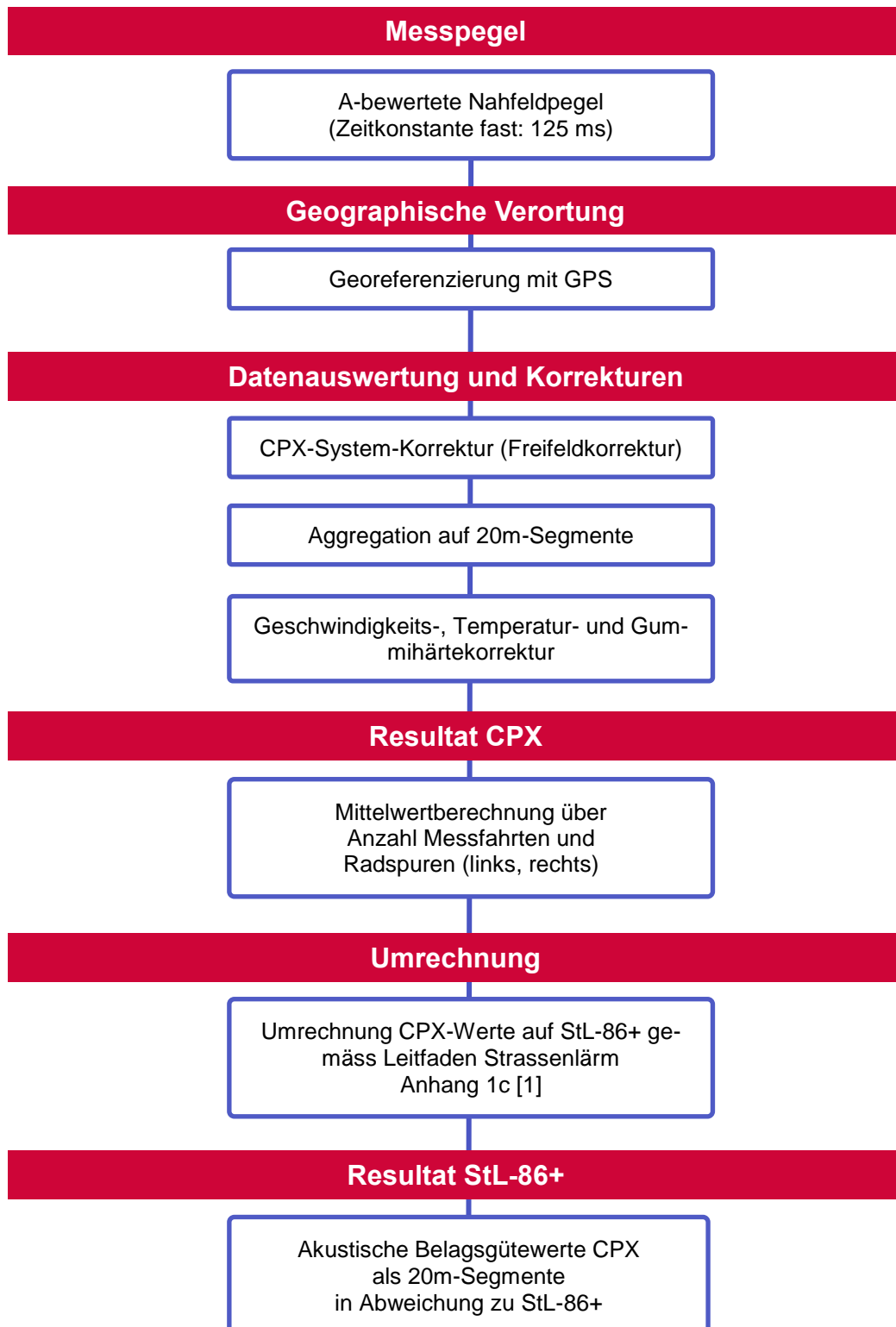
Abb. 4.4 Schema zum Vorgehen bei der Datenauswertung von CPX-Messungen.
